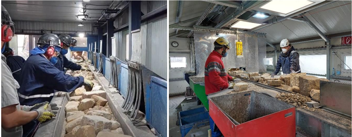
Figura 3 – Planta de seleção de reciclados – Brasil (esq.) e Áustria (dir.).
